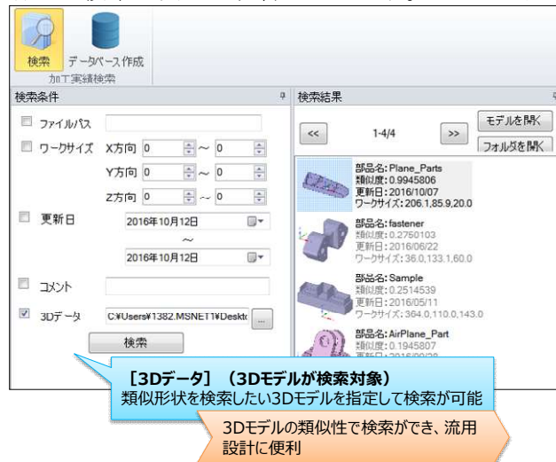
図 2 Simple Modeler に実装された形状類似検索機能
